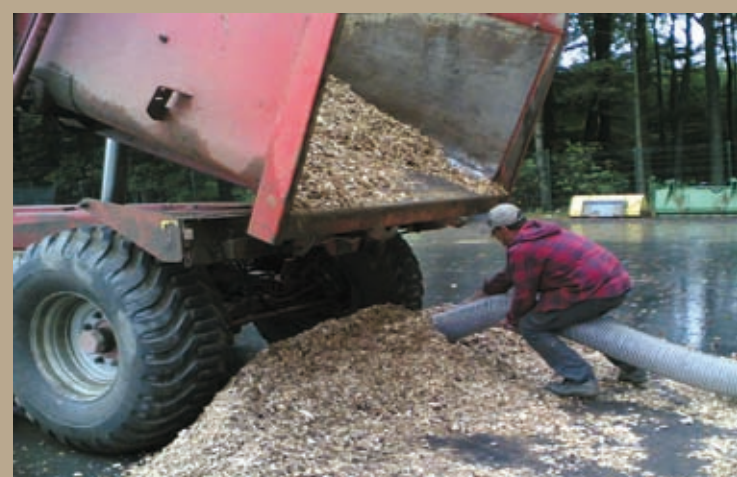
Die Heizung wird mit Hackschnitzeln beschickt
