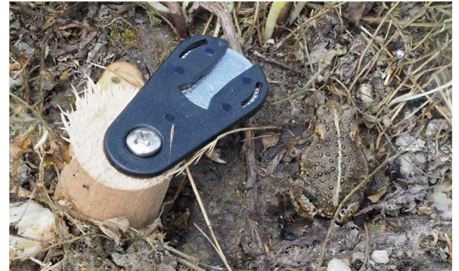
iButton Datalogger im Mikrohabitat
