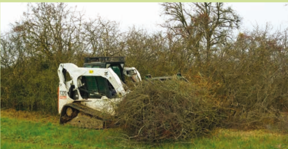
Der SICONA verfügt über zwei Kompaktlader, die durch ihren geringen Bodendruck optimal sind um das Schnittgut zusammenzudrücken und an den Rand der Parzelle zu transportieren.
