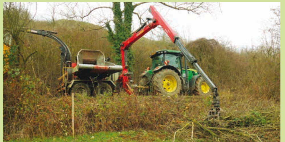
Anschließend wird das Material vom Forstkrane aufgenommen und dem Häcksler zugeführt. Die Hackschnitzel werden in einen Kipper geblasen und danach für eine weitere Nutzung abtransportiert.
