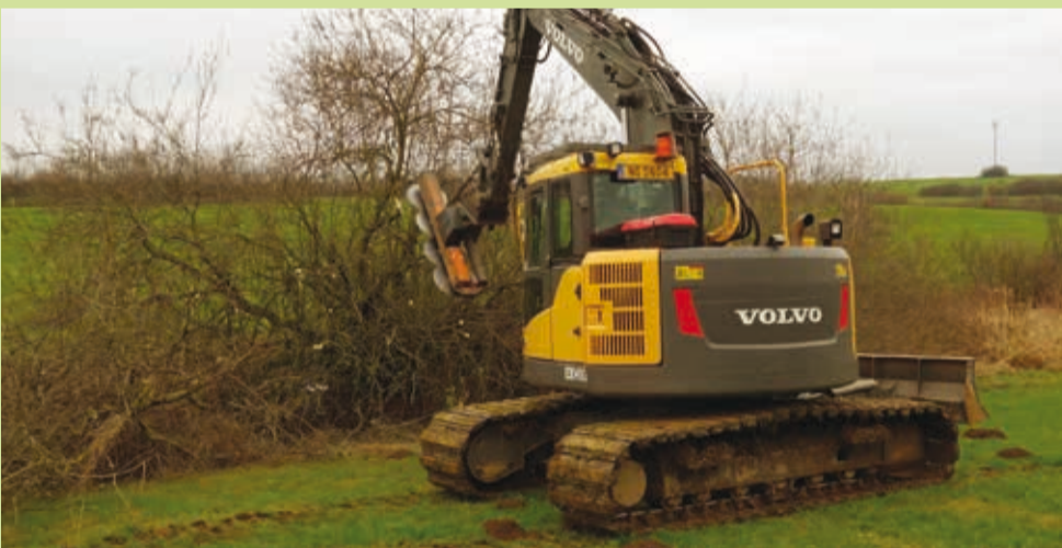
Beim Schnitt der Hecken in den Parzellen fallen Äste mit einem Durchmesser bis zu 10 cm an – hier nutzen wir einen hydraulischen Ausleger mit Säge, der es erlaubt dicke Äste sauber abzuschneiden. Bei dieser Technik muss das Material in weiteren Arbeitsgängen zusammengedrückt und gehäckselt werden. Insgesamt wurden 32 km Hecken im letzten Winter in Parzellen geschnitten.
