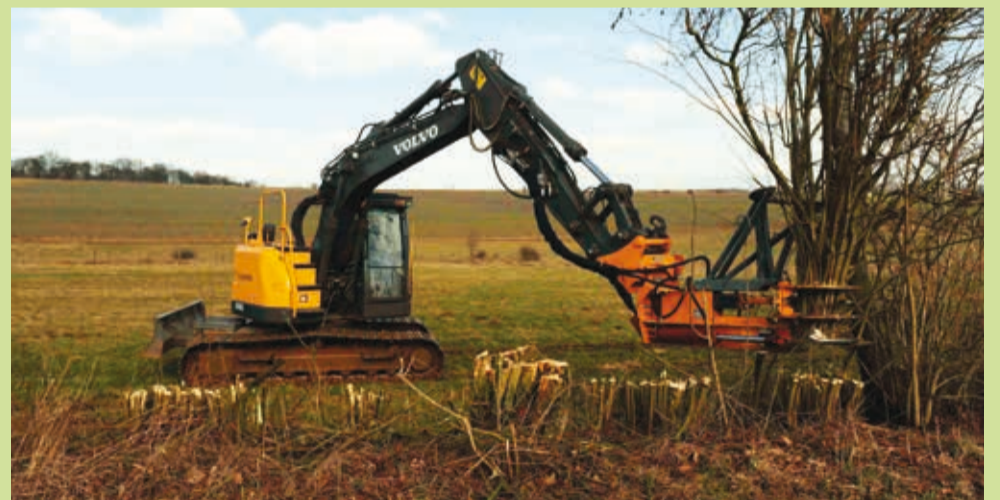
Um überalterte Hecken zu verjüngen müssen diese auf den Stock gesetzt werden. Hierbei setzen wir eine Heckenschere mit Entnahmegreifer ein. Diese Maschine greift zuerst die Hecke, schneidet danach ab und legt schließlich das abgeschnittene Material an gewünschter Stelle ab. Im Winter 20/21 wurden fast 3 ha Hecken in unseren Gemeinden verjüngt.
