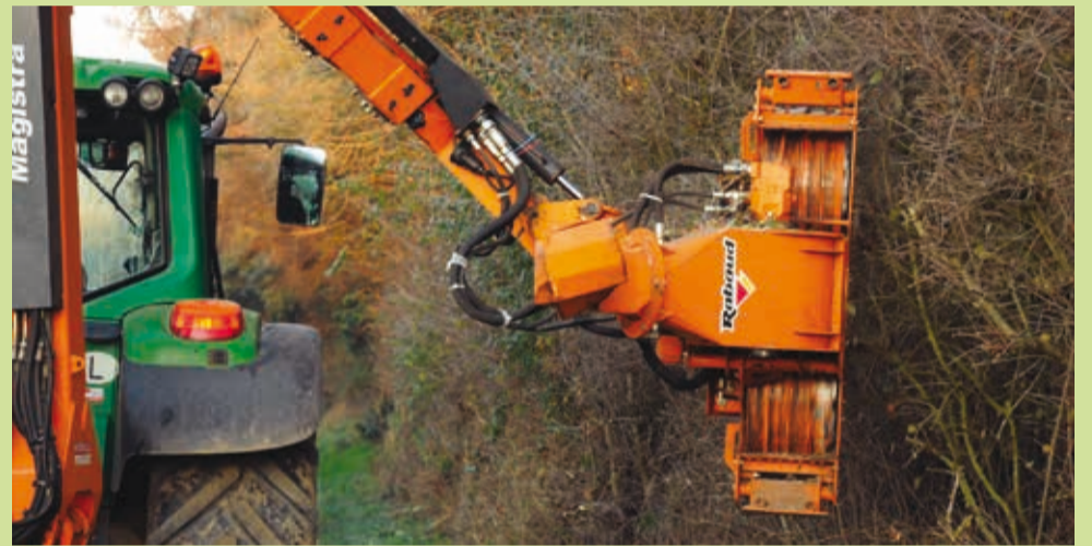
SICONA übernimmt in den meisten seiner 39 Mitgliedsgemeinden den Heckenschnitt entlang der Feldwege. Insgesamt wurden diesen Winter 310 km Hecken in der Offenlandschaft von uns geschnitten. Diese Spezialmaschine schneidet Äste bis etwa 2 cm Durchmesser sauber ab, nimmt sie auf, zerkleinert sie und bläst die Späne zurück in die Hecke. Da dabei auch immer wieder Äste auf den Boden fallen, muss manuell nachgearbeitet werden.
