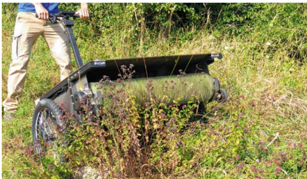
Abb. 5: Auf reifen Spenderflächen werden mit dem SeedHarvester eBeetle® autochthone Wiesensamen gewonnen. Foto: C. Wolff
